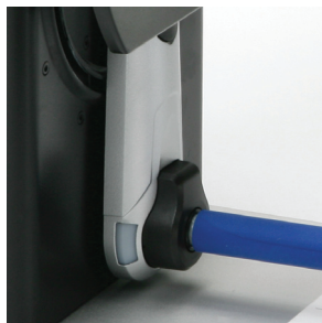
Farbige LEDs zur Statusanzeige des Aufwicklers
