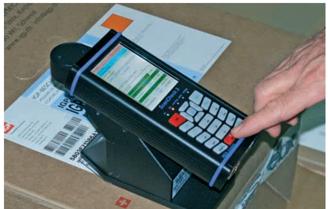
Prüfung von Barcodes im Warenausgang
