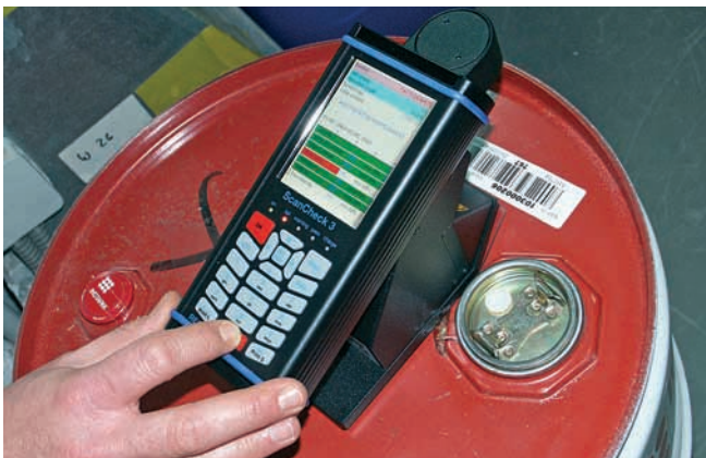
Prüfung von Barcodes auf Blechfässern
