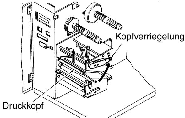
3. Legen Sie das Fanfold-Etikettenmaterial hinter den Drucker, und führen Sie dieses durch den Schlitz und über die Etikettenabwickelhalterung. Die zu bedruckende Seite der Etiketten muss nach oben zeigen. Schieben Sie die Etikettenabwickelführung so weit nach innen, dass diese direkt außen am Fanfold-Material anliegt.
