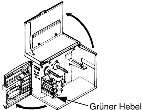
2. Öffnen Sie die Druckkopfeinheit, indem Sie die Kopfverriegelung in Richtung Druckerrückseite drehen. Die federbelastete Druckkopfeinheit öffnet sich automatisch, sobald die Kopfverriegelung gelöst wird.
