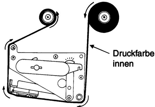
7. Wenn die Etiketten oder Anhänger bereits eingelegt sind, schließen Sie die Druckkopfeinheit. Drehen Sie hierzu die grüne Kopfverriegelung nach unten, bis diese einrastet.
