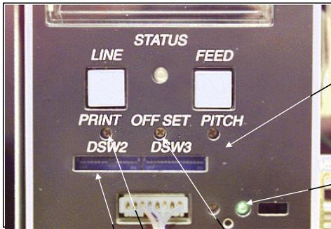
**PITCH-Potentiometer:** Dient zur Einstellung der Position des Etiketts (+/- 3,75 mm).
