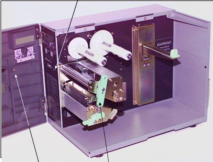
**HEBEL FÜR "DRUCKKOPF OFFEN":** Wenn der Druckkopf offen ist, wird ein Schalter aktiviert und der Drucker stoppt den Druckvorgang bzw. ist nicht betriebsbereit.
