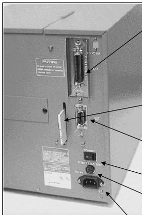
**PARALLELANSCHLUSS:** Für Druckerbetrieb mit parallelem Kommunikationsanschluss.
