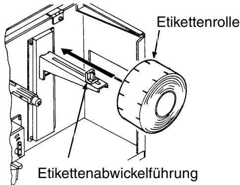
4. Schieben Sie die Etikettenmaterialrolle auf die Etikettenabwickelhalterung, wobei die zu bedruckende Seite der Etiketten beim Abwickeln von der Rolle nach oben zeigt. Schieben Sie die Rolle ganz nach innen und die Etikettenabwickelführung so weit nach innen, dass diese direkt außen an der Etikettenmaterialrolle anliegt.
