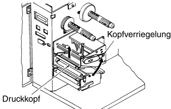
3. Schieben Sie das Farbband so weit nach innen auf die Farbbandabwickelspindel, dass dieses direkt am Ende der Spindel anliegt. Die Farbbandseite mit der Druckfarbe muss nach innen zeigen, während die Farbbandrolle im Gegenuhrzeigersinn abgewickelt wird.
