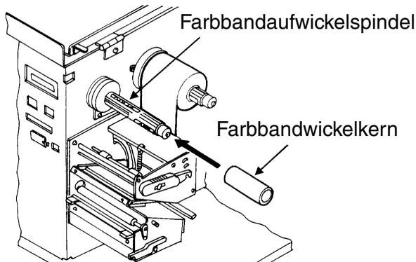
5. Führen Sie den vorderen Teil des Farbbandes durch die Druckkopfeinheit nach oben zur Farbbandaufwickelspindel, und kleben Sie diesen am Wickelkern fest. Drehen Sie die Aufwickelspindel von Hand, um das Farbband um den Kern zu wickeln. Nach ein bis zwei Umdrehungen ist es fest.
