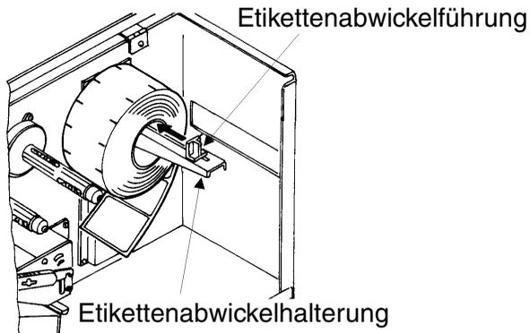
5. Führen Sie das Etikettenmaterial unter der Etikettenführungsbügel durch, weiter durch die Druckkopfeinheit und vorne aus dem Drucker heraus.
