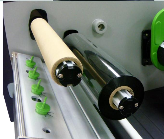
2. Installieren Sie Farbband und Aufwickelwalze auf der Farbbandversorgungsspindel und der Farbband-Aufwickelspindel. **Stellen Sie sicher, dass Farbband und Aufwickelwalzen in der Mitte der Spindel angebracht sind.** (Beachten Sie dazu das Lineal an den Spindeln.)
