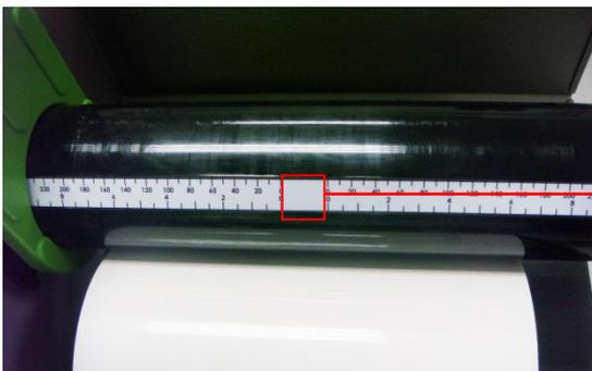
3. Prüfen Sie die Breite des Etiketts. (Beachten Sie dazu das Lineal an den Spindeln.)
