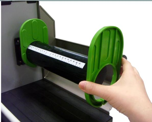
2. Entfernen Sie einen Etikettenrollenschutz von der Etikettenspindel.
