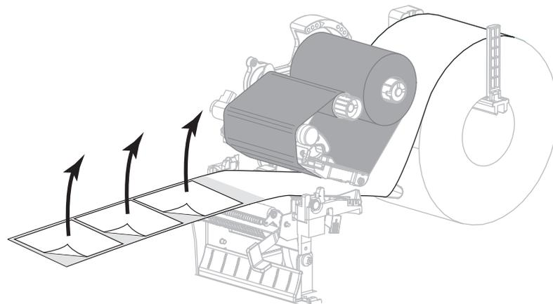
5. Ziehen Sie das Medium in den Drucker, sodass sich nur das Backing zwischen den Mediensensoren befindet.
