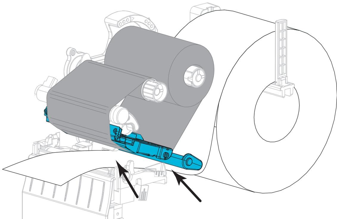
5. Stellen Sie sicher, dass das Medium durch den Schlitz im Durchlichtsensor (1) und unter der inneren Medienrandführung (2) durchgeführt ist. Das Medium sollte das hintere Ende des Schlitzes am Durchlichtsensor gerade berühren.
