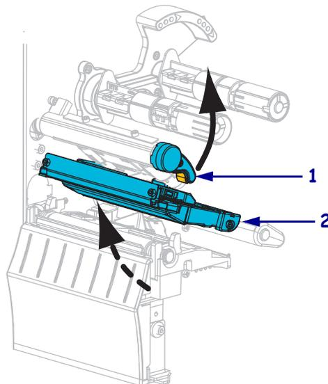
2. Bringen Sie das Farbband in Position, indem Sie das lose Ende im Uhrzeigersinn abrollen.
