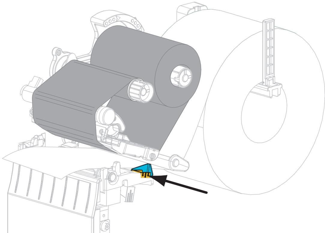
8. Drehen Sie den Hebel zum Öffnen des Druckkopfes im Uhrzeigersinn, bis der Druckkopf einrastet.
