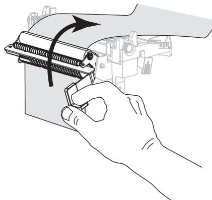
9. Drehen Sie den Hebel zum Öffnen des Druckkopfes nach unten, bis der Druckkopf einrastet.
