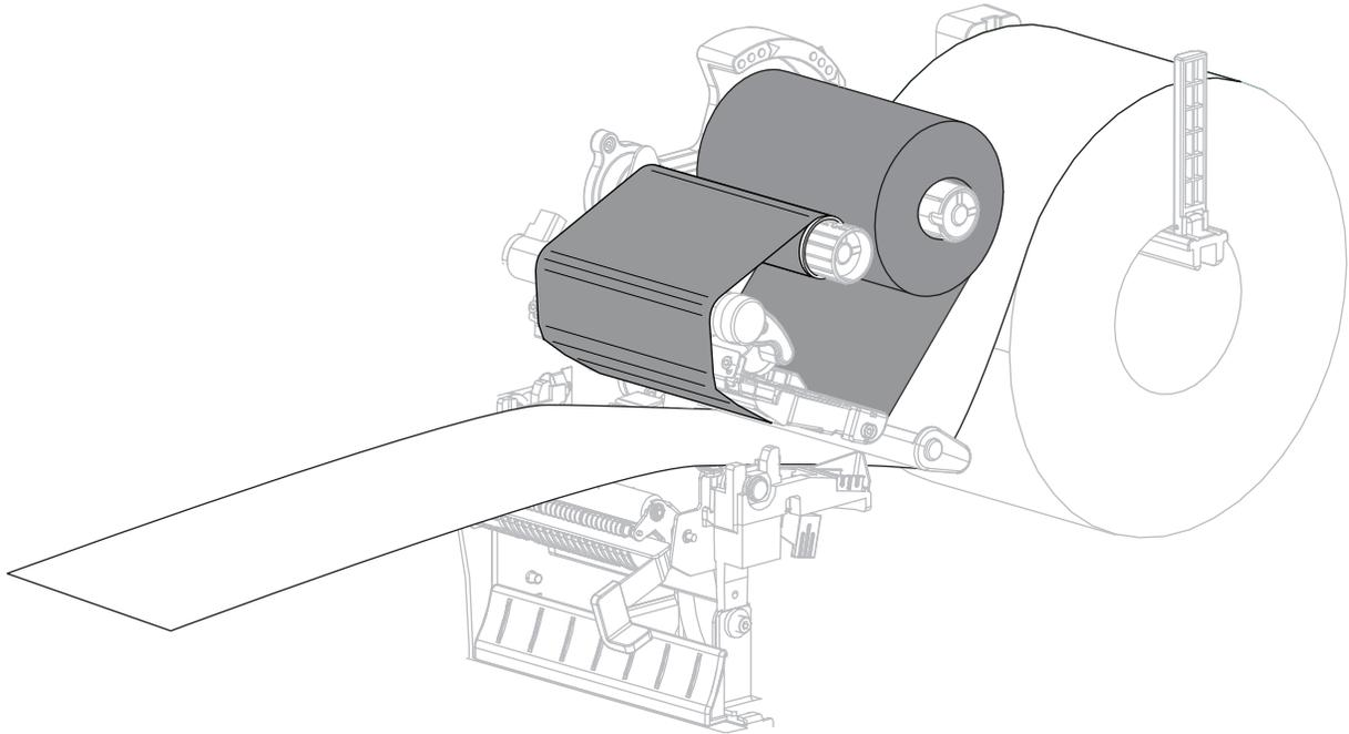
15. Entfernen Sie die freigelegten Etiketten, sodass nur das Trägermaterial übrig bleibt.
