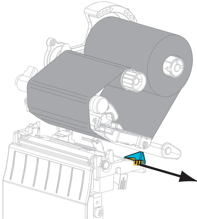
4. Schieben Sie die Medien unter die Medientänzeinheit und den Druckmechanismus. Schieben Sie das Medium so weit hindurch, dass es aus der Vorderseite des Druckers herausragt.
