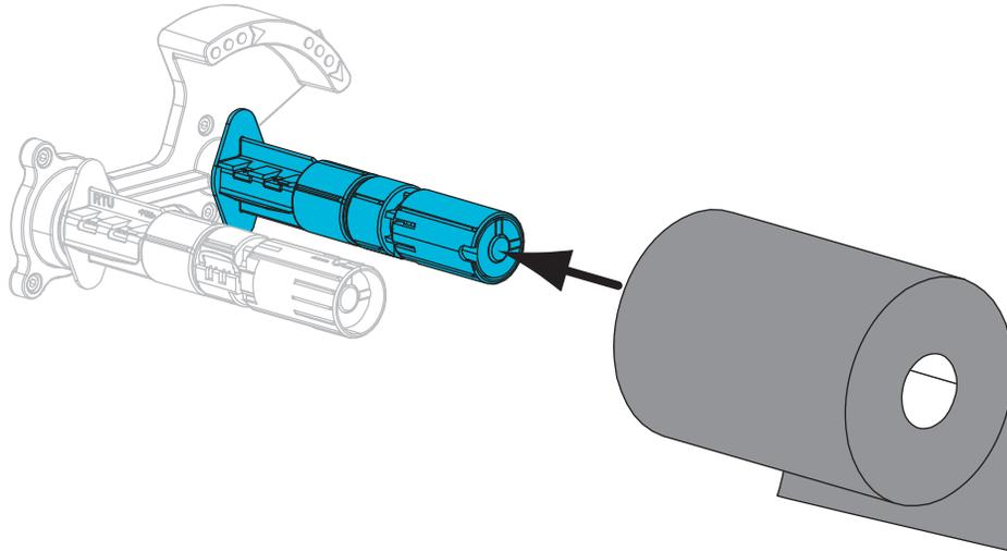
4. Der Drucker wird mit einem leeren Farbbandkern auf der Farbband-Aufwickelspule geliefert. Falls dieser Kern nicht mehr da ist, setzen Sie einen leeren Farbbandkern auf die Farbband-Aufwickelspule. Schieben Sie den Kern so weit wie möglich nach hinten.
