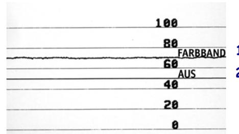
**Mediensensorprofil (Abbildung 22)** Die Werte des Farbbandsensors werden durch Streifen (1) auf dem MEDIUM dargestellt. Die Schwellwerteinstellung des Mediensensors wird durch WEB (2) (NETZ) angezeigt. Der Schwellenwert für ein fehlendes Medium wird durch OUT (3) (Medium fehlt) angezeigt. Die nach unten gerichteten Spikes (4) weisen auf Lücken zwischen den Etiketten hin (das Netz), und die Linien zwischen den Spikes (5) geben die Position der Etiketten an.
