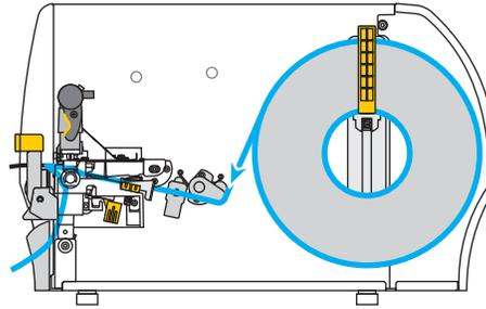
13. Drücken Sie den Freigabehebel des Abziehmechanismus nach unten, um die Abzieheinheit zu öffnen.
