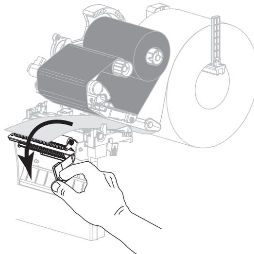
4. Entfernen Sie alle Medienträgermaterialien, um die Klemmrolle freizulegen.
