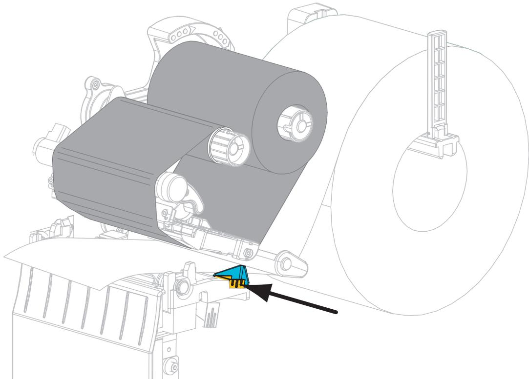
**20.** Drehen Sie den Hebel zum Öffnen des Druckkopfes im Uhrzeigersinn, bis der Druckkopf einrastet.
