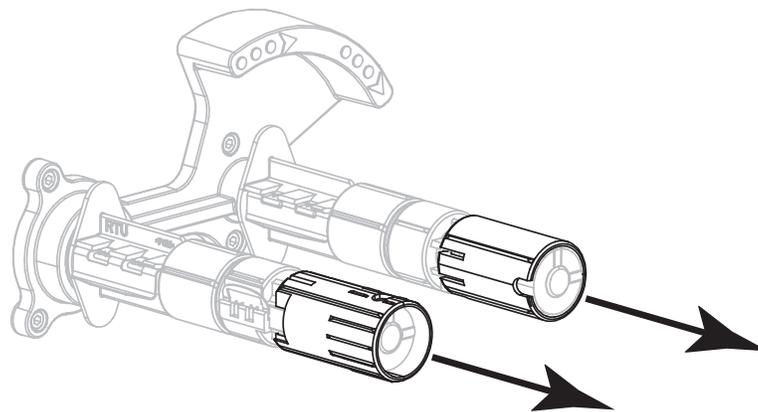
**Einstellung der niedrigen Spannung** Um die Farbbandspule auf die **Position für niedrige Spannung** einzustellen, schieben Sie die Endabdeckung der Spule, wie in [Abbildung 13](#) dargestellt, bis zum Einrasten auf die Spule. Verwenden Sie diese Einstellung nur, wenn es notwendig ist, z. B. wenn das Farbband am Anfang einer Rolle Abriebspuren aufweist oder sich bei normaler Spannung am Ende der Rolle verklemmt.
