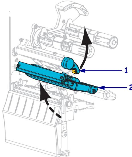
3. Drücken Sie den Freigabehebel des Abziehmechanismus nach unten, um die Abzieheinheit zu öffnen.
