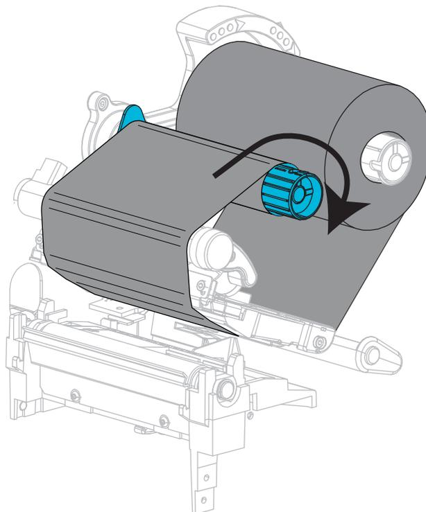
7. Sind bereits Medien eingeführt, drehen Sie den Hebel zum Öffnen des Druckkopfes im Uhrzeigersinn, bis der Druckkopf einrastet. Anderenfalls fahren Sie mit *Einlegen von Medien auf Seite 60* fort.
